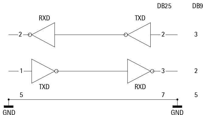
Schéma de connexion d'un ordinateur ou autre périphérique à la balance à l'aide d'un câble RS-232 long de 15 mètres.
