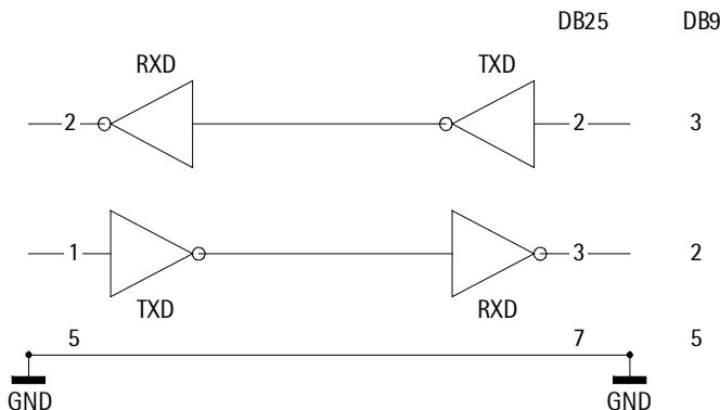
Diagrama para conectar un ordenador o dispositivos periféricos diferentes a una báscula mediante un cable RS-232 con una longitud de hasta 15 m.
