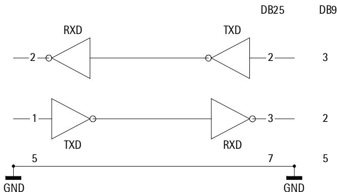
Verbindung mit einem Computer oder einem anderen Peripheriegerät über ein Kabel RS-232 mit einer Länge bis zu 15 m.
