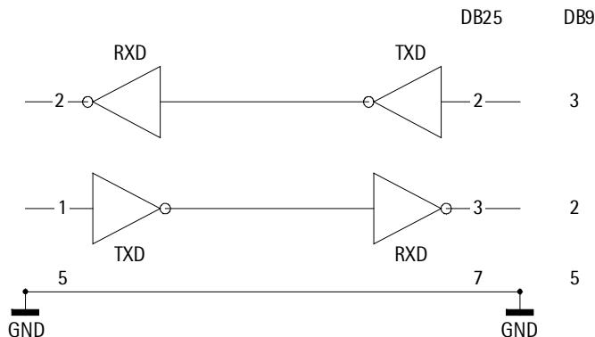
Schema per interfacciare un computer o un altro apparecchio periferico alla bilancia usando il cavo RS232 avente una lunghezza fino a 15 m.
