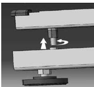
Vor Verwendung der Waage die Mutter nach oben drehen, bis sie fest sitzt.
